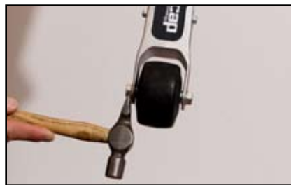
Bakhjulet går ut mot vänster. Slå in hjulet som på bilden.
