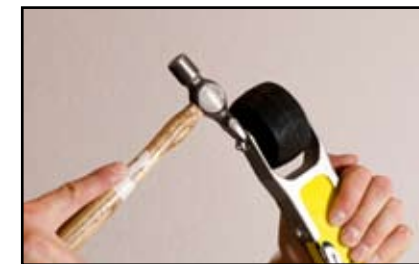
Framhjulet går ut mot höger. Slå in hjulet som på bilden.
