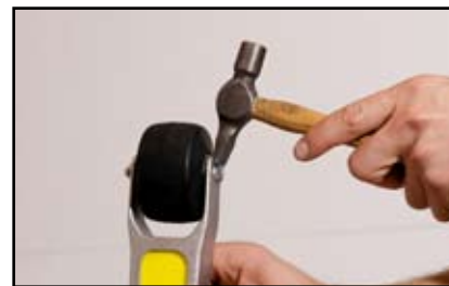
Framhjulet går ut mot vänster. Slå in hjulet som på bilden.
